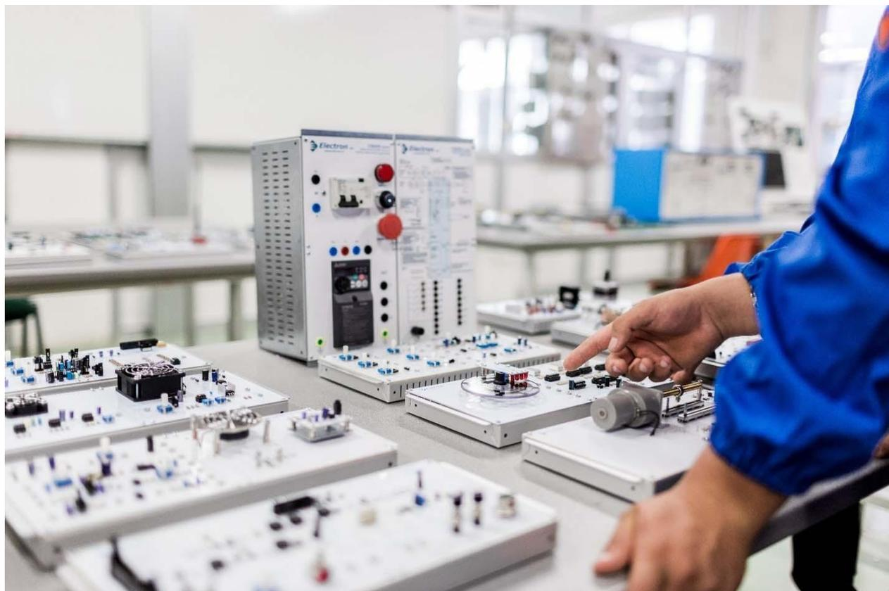
Questo laboratorio comprende vari moduli per sperimentare circuiti e principi comunemente ricorrenti nel campo dell'elettronica di potenza, trasduttori e controlli.
