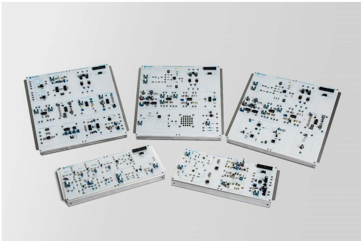
La dotazione di laboratorio comprende vari moduli per mostrare e sperimentare circuiti e principi comunemente ricorrenti nel campo dell'Electronica di Base fino alla microelettronica. È consigliato agli studenti che frequentano i successivi corsi di elettrotecnica ed elettronica. I moduli sono generalmente costituiti da schede PCB con componenti a vista, particolarmente adatte al lavoro individuale degli studenti o al lavoro in un piccolo gruppo.
