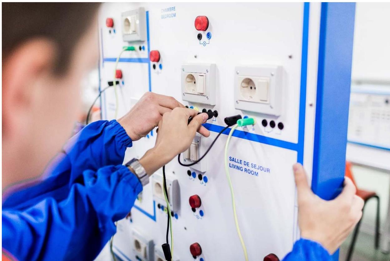
Il laboratorio è costituito da un insieme integrato di moduli formativi comunemente ricorrenti nel campo degli Impianti Elettrici, in contenitori metallici (o scatole isolate) con un chiaro sinottico che ne illustra la logica interna. Ogni modulo contiene una specifica funzione elettrica che può essere collegata agli altri per realizzare diverse combinazioni circuitali ed eseguire esperimenti anche complessi.
